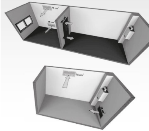
Şekil 1.3.1: B3 Model Havalandırma Sistemi
